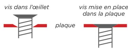
*Les têtes de vis s'adaptent parfaitement au chanfrein des œillets des plaques*
